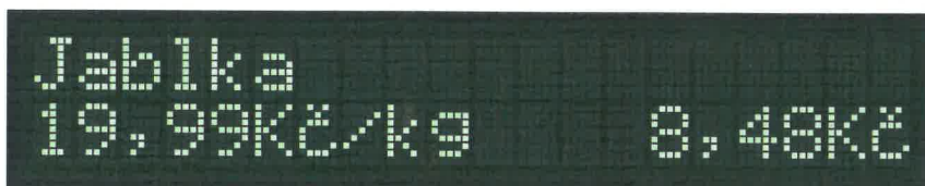
Obrázek 1: Zákaznický displej 2x20 znaků – zobrazení vážené položky s předvolenou tárou
