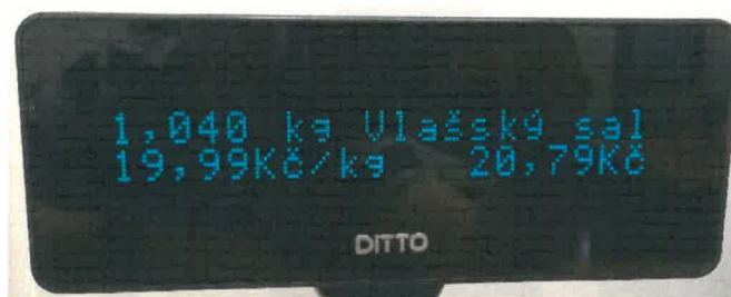
Obrázek 2: Zákaznický displej 2x20 znaků – zobrazení vážené položky bez předvolené táry
